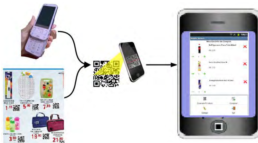
Figura 1. Funcionamento de leitura do módulo Mobile, mostrando a leitura do QR Code e o acesso do produto no sistema da loja.
