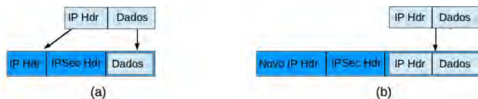
Figura 3. Modo transporte (a) e modo túnel (b) do IPsec.
