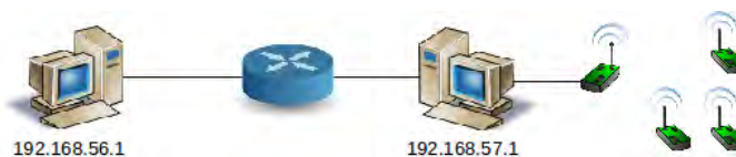
Figura 4. Arquitetura básica IPv4 para montagem de VPN via IPSec.
