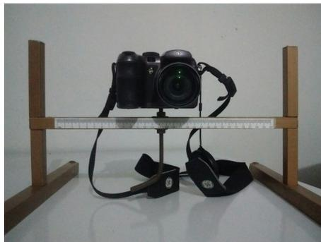
Figura 1. *Gantry* planar construído durante o projeto.
